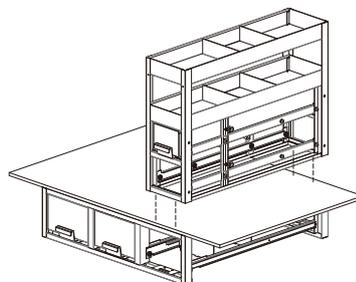
奥行950mmタイプのバンキャビネットと連結使用可能(取り付け穴の加工が必要)
