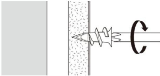
ドライバーで直接ネジ込む
