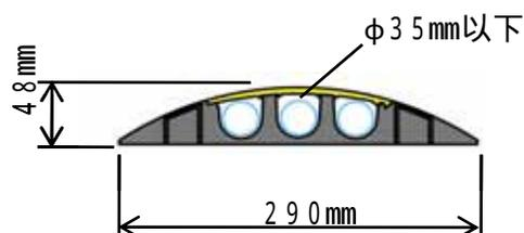
野外でのハードな使用にも耐える連結型ケーブルプロテクター
