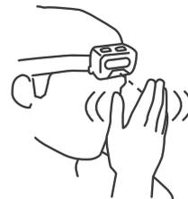
タッチレスセンサーの前で手を1回往復すると点灯します。再度、手を1回往復すると消灯します。
