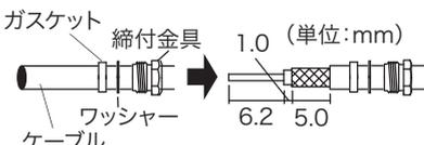
**3** クランプを挿入し、外部導体をほぐして折り返し、クランプよりはみ出た部分をカットする。
