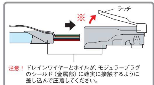
**注意!** ドレインワイヤーとホイルが、モジュラープラグのシールド(金属部)に確実に接触するように差し込んで圧着してください。
