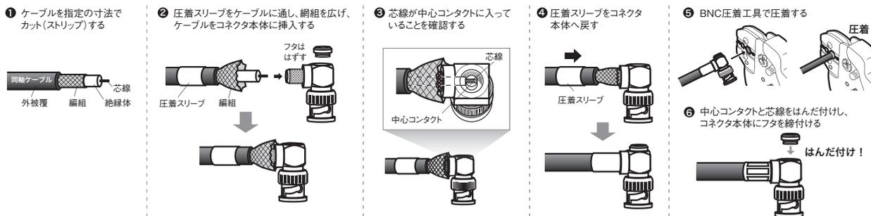
※50Ωタイプの接合で75Ωのケーブルを使用する場合は周波数が200MHz以下であれば、75Ωの伝送ラインで使用可能ですが、200MHzを超えるときは、BNC75Ωタイプの使用をお勧めします。
