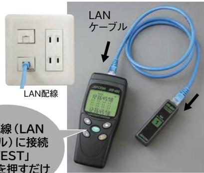
LAN配線 (LANケーブル) に接続して「TEST」ボタンを押すだけ
