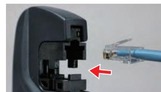
プラグを差し込んで圧着してください。圧着が完了するとグリップが解除されます。
