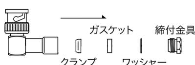
**2** ケーブルに締付け金具、ワッシャー、ガスケットの順に通し、ケーブルを図の寸法でカットする。
