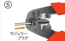
⑤ プラグを圧着工具に差し込み圧着します。
