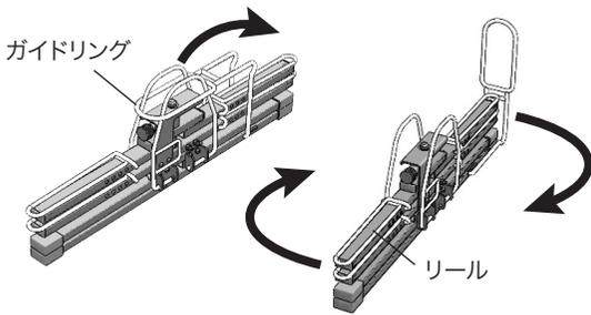
**1** 可倒ガイドリングを矢印の方向に立たせる。
