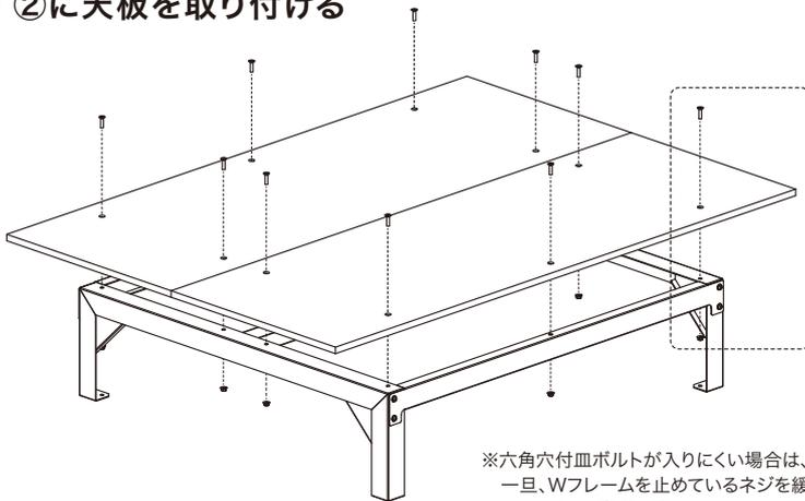
※六角穴付皿ボルトが入りにくい場合は、一旦、Wフレームを止めているネジを緩めてから、再度締め直してください。
