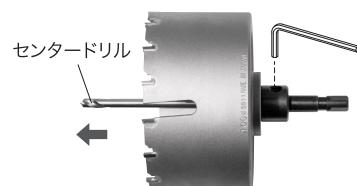
付属の六角レンチでホールソーのネジをゆるめ、センタードリルを取り外します。
