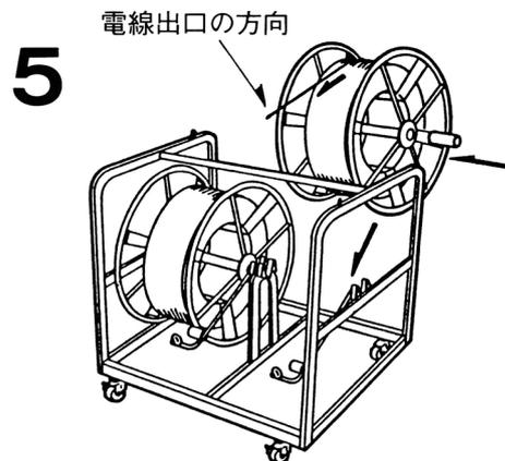
リールフレームにマジックリールドラムを入れ、セット完了。(電線をセットした状態)
