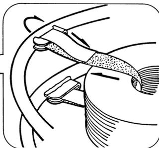
電線の束をマジックリールドラムに入れ、マジックテープで固定する。(その際、可動側リールの裏表をまちがえないようにして下さい。)
