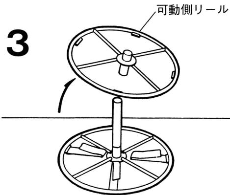
リールフレームよりマジックリールドラムをはずし、マジックリールドラムの右側のシャフト(短い方)を矢印の方向にはずす。
