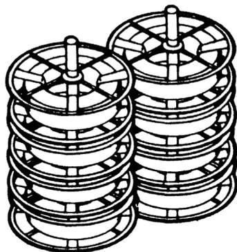
※取り出したマジックリールドラムは2個以上、真ん中のシャフト部凹凸の結合により、芯ズレのない積重ね保管ができる。
