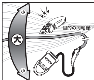
同軸線の配線探査イメージ
