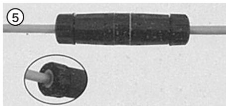
エンドキャップをカバーに締め込んでください。この時、キャップが変形していないことを確認してください。以上で完成です。
