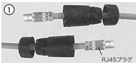
LANケーブルの片側のRJ45プラグをエンドキャップ、カバーに通してください。
