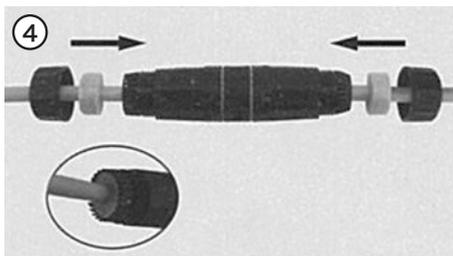
カバーとエンドキャップの間にキャップを向きに注意して取付けてください。キャップの径が小さくなっている方がエンドキャップ側です。キャップをカバーの内側に収納してください。この時、カバーのジャバラ部分が変形していないことを確認してください。
