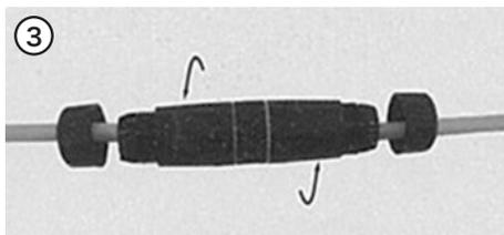
カブラーにリングが付いていることを確認し、カバーを締め込んでください。カバーは締め過ぎないでください。締め過ぎるとリングが破断します。
