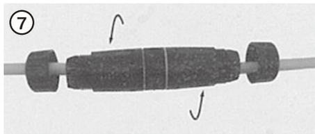
カプラーにリングが付いていることを確認し、カバーを締め込んでください。カバーは締め過ぎないでください。締め過ぎるとリングが破断します。
