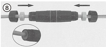
カバーとエンドキャップの間にキャップを向きに注意して取付けてください。キャップの径が小さくなっている方がエンドキャップ側です。キャップをカバーの内側に収納してください。この時、カバーのジャバラ部分が変形していないことを確認してください。
