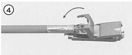
接続器のカバーを開け、上図のようにLANケーブルを通したロードバーを接続器のピンに対応するように合わせてカバーを閉じます。この時、ロードバーが接続器に隙間なく密着していること。
