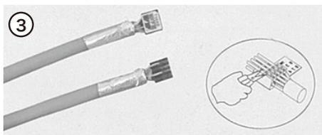
ロードバーに記載されている線色に従って線を通します。ロードバーからはみ出した線はカットし先端を切り揃えます。
