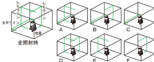
※レーザー半導体素子は、非常に繊細な電子部品です。EとFのように、同じような用途の場合でも、レーザー素子の偏った寿命を防ぐ為に、左右のレーザーをまんべんなくご使用ください。
