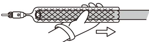
⑤ケーブルグリップの後端部付近を、番線などで十分にバインド(=しぼる)します。2~3cm間隔で3カ所ほどしぼるとより効果的です。
