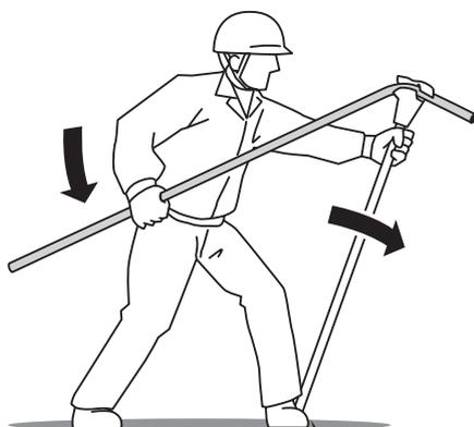
支柱用電線管の先端は滑りやすいので注意してください。
