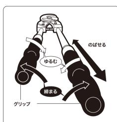
グリップを回し、ハンドル長を固定する時、 過度の力を加えますと、ハンドル固定機構 が破損する場合がありますので注意してく ださい。
