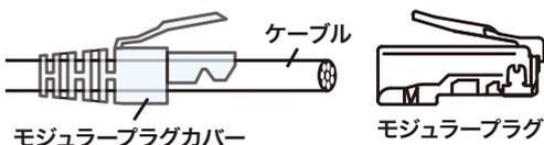
③本製品をモジュラープラグに差し込み、圧着工具で圧着します。
