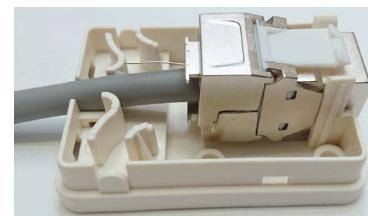
キーストンジャックを下カバーに取付けます。
