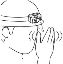
タッチレスセンサーの前で手を通過させると点灯します。再度、手を通過させると消灯します。
