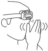
タッチレスセンサーの前で手を通過させると点灯します。再度、手を通過させると消灯します。
