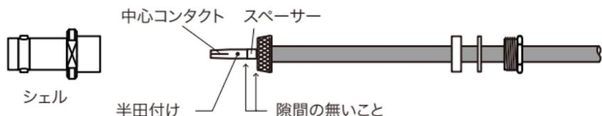
⑤ シェルを装着し、締付金具をスパナ等で締め付ける。
