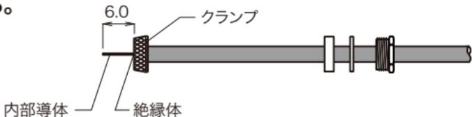
④ 内部導体にスペーサーを通してから中心コンタクトを装着し、半田付けする。絶縁体、スペーサー、中心コンタクトの間に隙間が無いこと。
