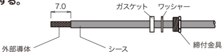
③ クランプを装着し、外部導体を折り返して切りそろえ、内部導体を指定の寸法でカットする。
