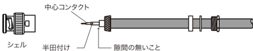
⑤ シェルを装着し、締付金具をスパナ等で締め付ける。
