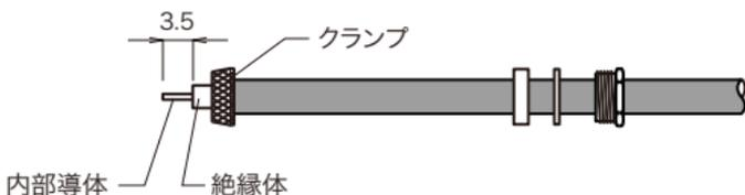
④ 内部導体に中心コンタクトを装着し半田付けする。
