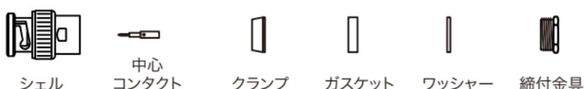
② 締付金具、ワッシャー、ガスケットの順にケーブルに通し、シースを指定の寸法でカットする。
