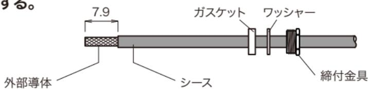
③ クランプを装着し、外部導体を折り返して、絶縁体を指定の寸法でカットする。
