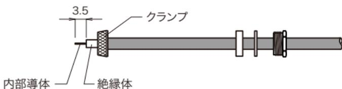
④ 内部導体に中心コンタクトを装着し半田付けする。中心コンタクトと絶縁体の間に隙間の無いこと。
