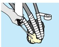
※アワフォームは固まると化学的に不活性化状態となりますが、電線などに対して作業する場合は万一の電線の腐食を防止するため、絶縁防水テープを巻いた後、アワフォームをご使用ください。
