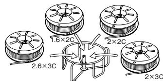
Fリール1台でバック取替もOK。異なるサイズの電線を装着し、必要に応じて取り替え使用
