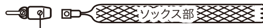
このネジを外すことでソックス部を分離・交換できる
