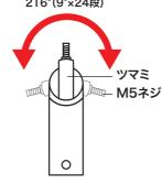
ツマミを回して M5ネジの角度を 調節できます。
