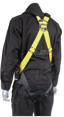
肩・腿ベルト:幅45mmポリエステル 胸ベルト:幅25mmナイロン 肩パックル:スチール 胸クリップ:ワンタッチタイプ(アルミ合金) 腿パックル:ワンタッチパックル(アルミ合金) ワークポジショニング用器具接続ベルト:ワンタッチタイプ (アルミ合金)
