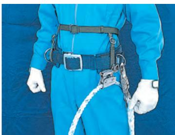
ワークポジショニング用器具を吊り下げるようにして補助帯を胸部に締めておけば、工具類で重くなったワークポジショニング用器具が下がることはありません。またワークポジショニング用器具のすり抜け防止にも有効です。
