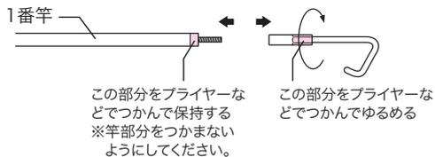
※既設のフック金具はゆるみ防止のために、非常に硬く締め付けてあります。取り外しの際はプライヤーなどを使い、十分に注意してください。また取り付け後は、ゆるみ止めのために必要に応じてテーピング、またはネジロック剤をご使用ください。
