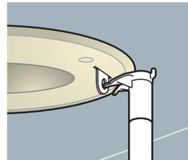
樹脂製輪部を引張る操作が可能突起部を輪の中に入れて操作します。先端に厚みを持たせているので抜けにくくなっています。
