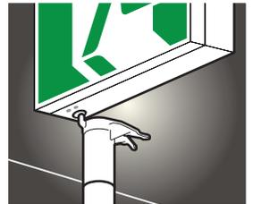
点検ボタンを押す操作が可能突起部を点検ボタンの位置に合わせ、押し上げて確認します。
