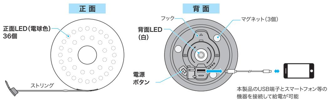
[内蔵電池] リチウムポリマー電池 (3.7V 2000mAh)
