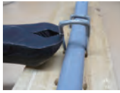
テコの原理で、配線用 ステップルを軽く抜ける
