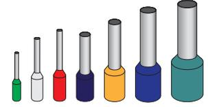
フェール端子は、電線(より線)のパラケを防止し、電気接続の品質を安定させる欧州式棒端子で、端子台の形状を小さくするために考案された、より小型の棒形圧着端子です。
