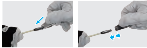
解除ツール中央部の突起で、ロックボタンを押して解除する
