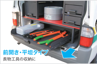
引き出しを出さなくても、前面の隙間から、 工具の出し入れが可能
