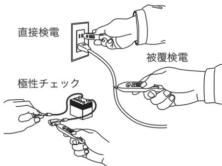
交流電圧の活線状態を接触・非接触で確認できる検電器
