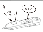
図7 直接検電 AC200V
