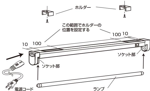
1. ホルダーをランプの長さに合わせて確実に固定する。
