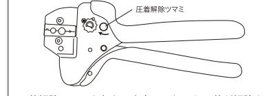
圧着解除ツマミを矢印の方向にひねると圧着が解除されます。
