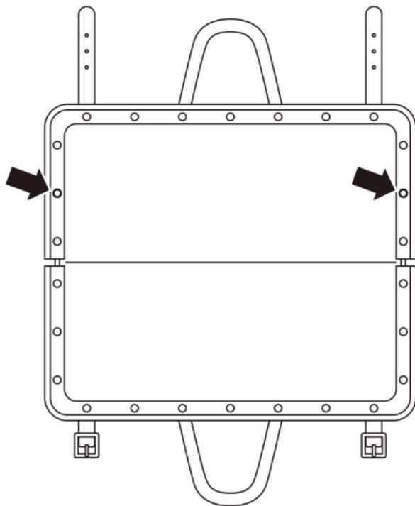
2. リベット穴に合わせて、バッグの外側にリベットでストラップ用の金具を取り付ける
