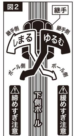
**⚠️ 注意** ポールの継手は軽く締めてください。強く締めると緩まなくなり、ロック機構を破損する恐れがあります。
