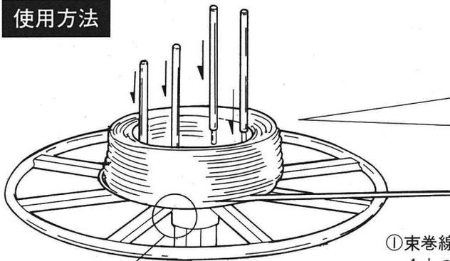
①束巻線を回転台の中央に乗せ内径に合わせて4本のバーをセットホールに差し込み、セットしてください。
