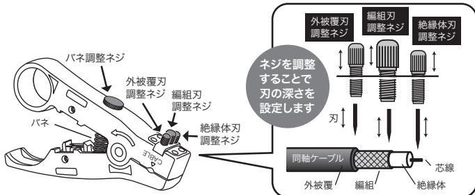
① 刃調整用の同軸ケーブルを用意します。
