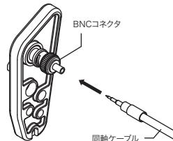
※同軸ケーブルとコネクタを接続する前に、使用するコネクタの規格に合わせてメーカー推奨の長さで剥き処理を行ってください。
