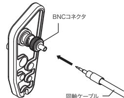
※同軸ケーブルとコネクタを接続する前に、使用するコネクタの規格に合わせてメーカー推奨の長さで剥き処理を行ってください。
