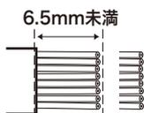
A配線もしくはB配線に並替えます。よりを戻したワイヤー部分が6.5mm未満になるようにカットします。
