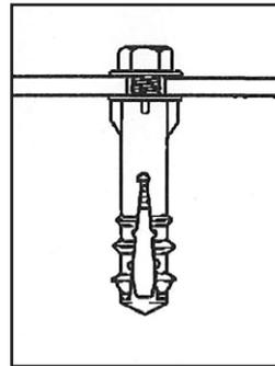
④取り付け物を据え、適合のボルトで締め付ける。
