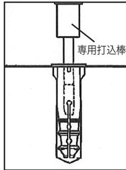
③アンカーを下穴に挿入し、専用打込棒で内部コーンを打ち込む。
